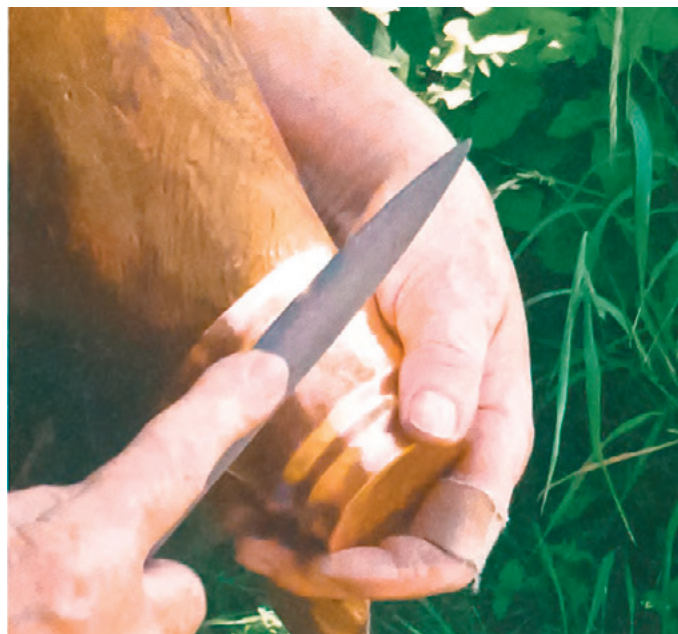
Hammerspuren können als Oberflächenstruktur belassen oder weggefeilt und geschliffen werden.
