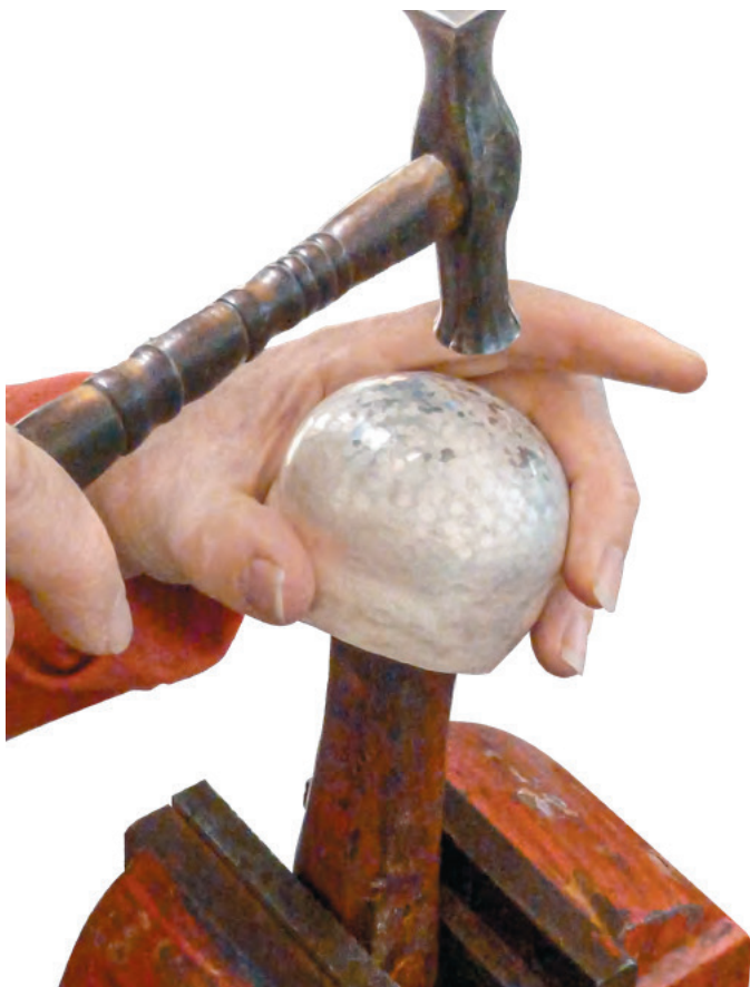
Durch Planieren wird das Werkstück geglättet.
